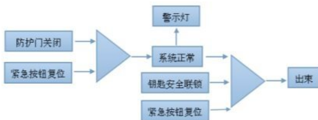
图 10.2 门机联锁逻辑图
