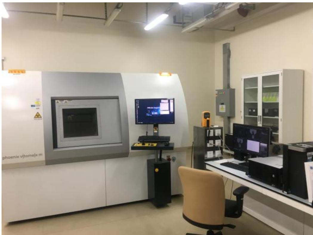
图 3.2 v|tomo|x m 240 型 X 射线检测装置示意图
